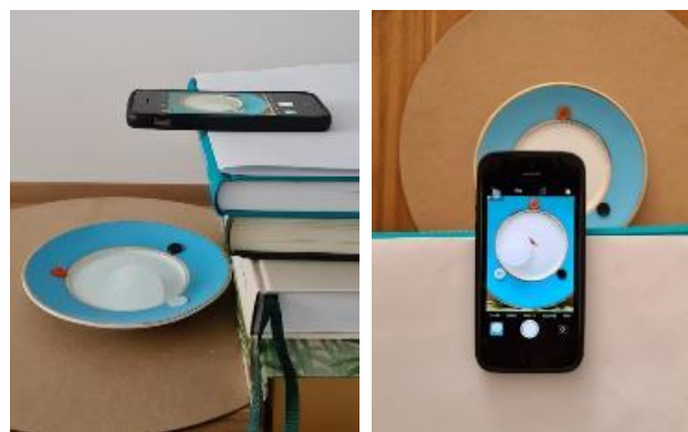
Uso de un móvil para evaluar el hielo que se derrite. La imagen superior es una vista lateral y la inferior una vista superior. (Fuente: ESA CCI)
